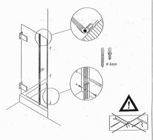
Magnetleistenträger an Dichtung anhalten, anzeichnen, bohren und verschrauben
