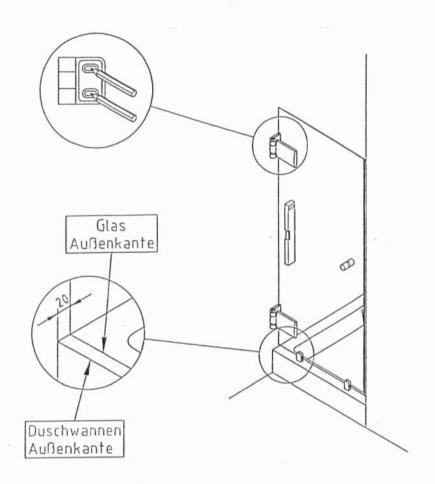
Tür ausrichten und Bohrungen anzeichnen
