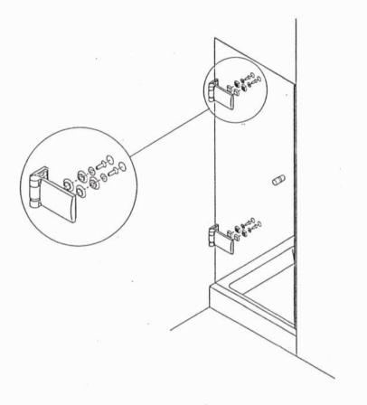
Bänder an der Tür befestigen und ausrichten
