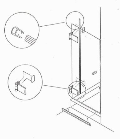
· Dichtungen aufstecken und Dichtlippe an den Bändern einschneiden Kappen aufkleben
