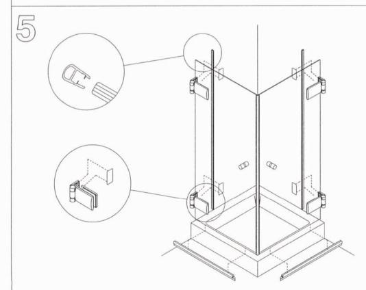
Dichtungen aufstecken und Dichtlippe an den Bändern einschneiden Kappen aufkleben
