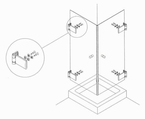
Bänder an der Tür befestigen und ausrichten
