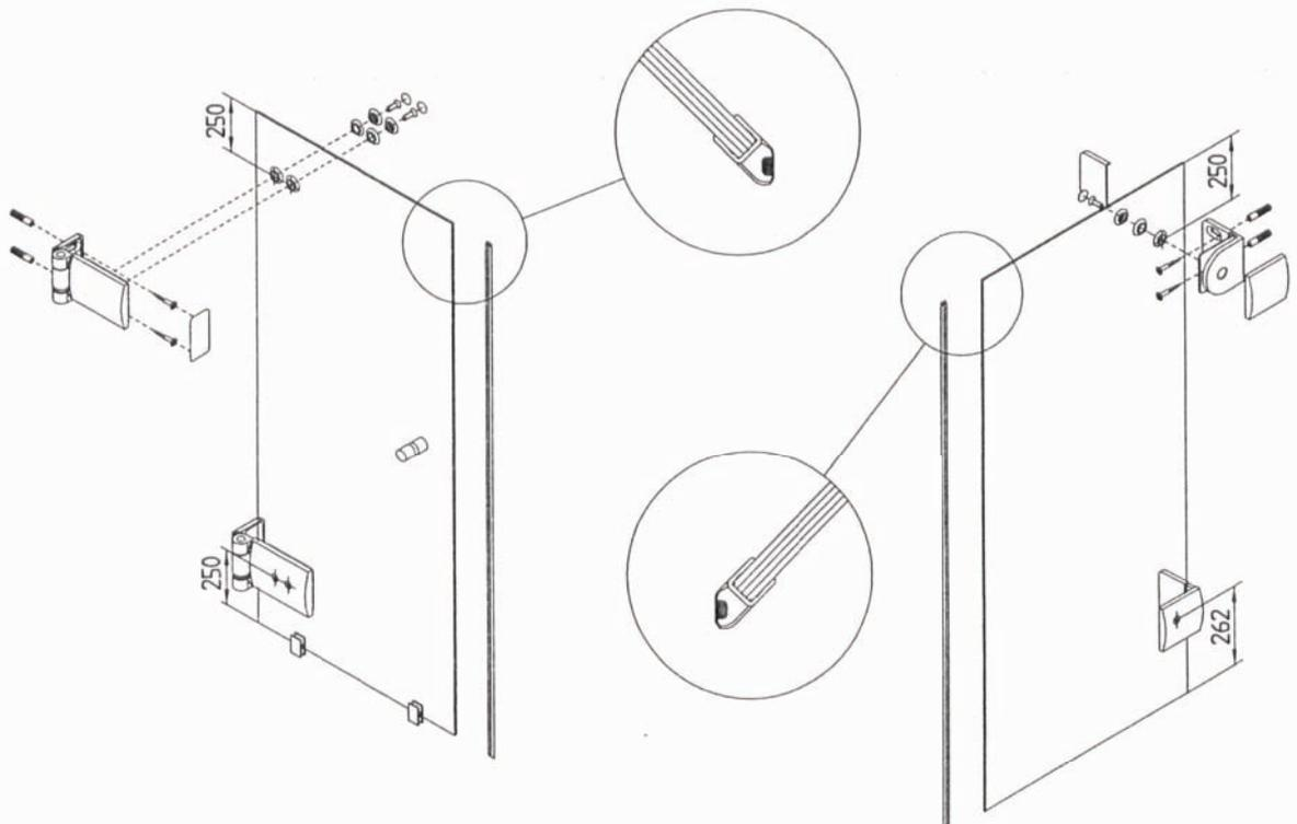
Bänder, Winkel und Knopf ans Glas schrauben, Dichtungen aufstecken
