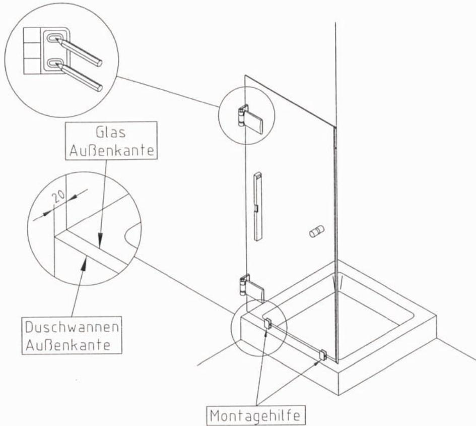
Tür ausrichten und Bohrungen anzeichnen
