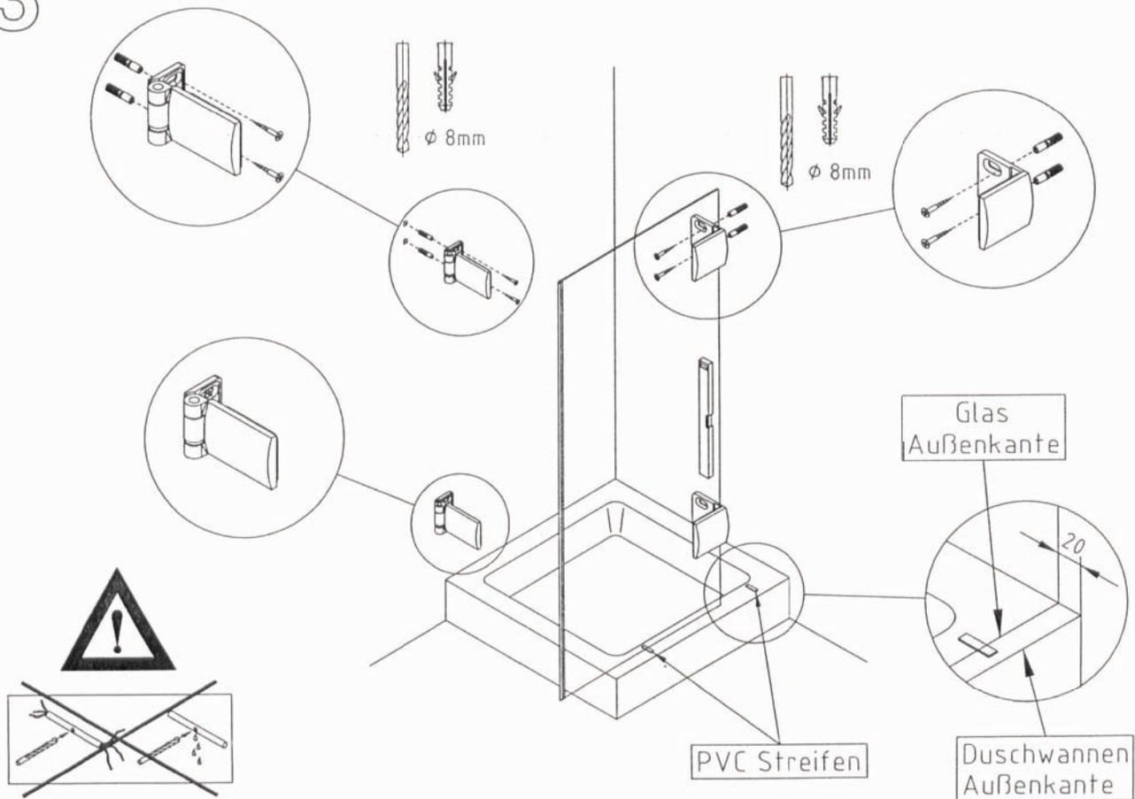
Löcher bohren & Bänder und Winkel anschrauben
