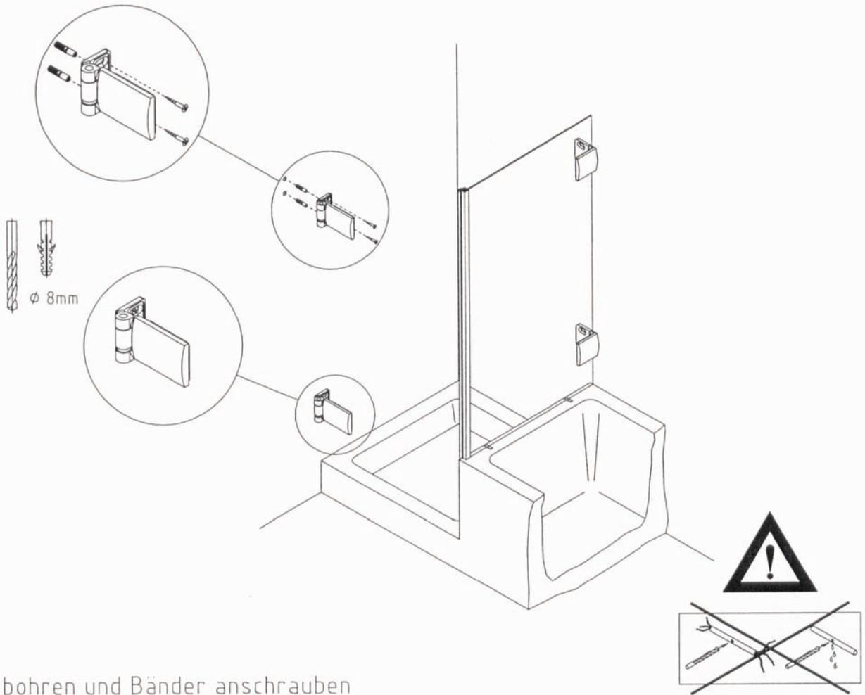
Löcher bohren und Bänder anschrauben
