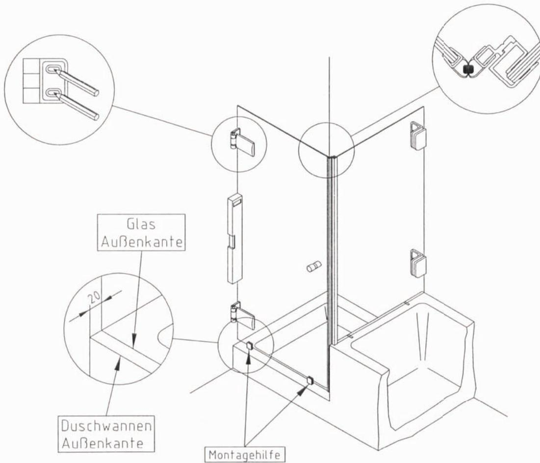
Tür ausrichten und Bohrungen anzeichnen
