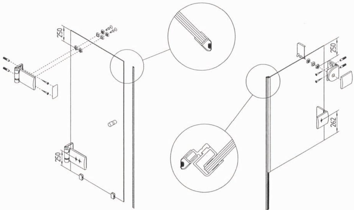
Bänder, Winkel und Knopf ans Glas schrauben, Dichtungen und Profile aufstecken
