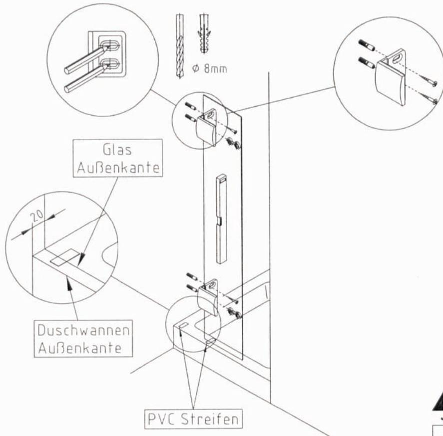
Fixteil ausrichten, anzeichnen, bohren und verschrauben
