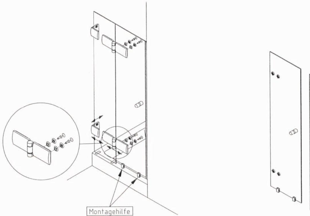
Knopf montieren, Dichtung und Montagehilfen aufstecken
