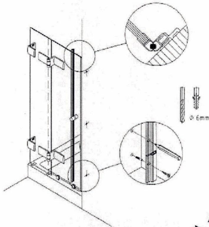
Magnetleistenträger an Dichtung anhalten, anzeichnen, bohren und verschrauben
