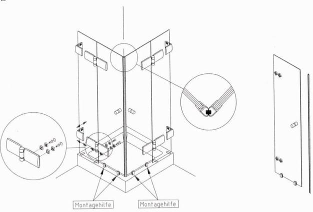
Knöpfe montieren, Dichtungen und Montagehilfen aufstecken Türen montieren und ausrichten
