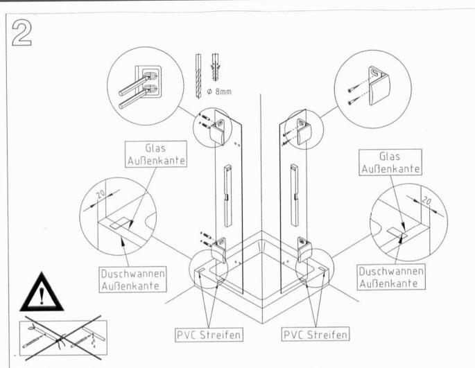
Fixteile ausrichten, anzeichnen, bohren und verschrauben
