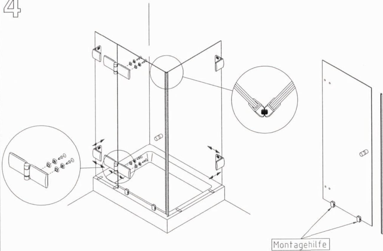
Knopf montieren, Dichtung und Montagehilfe aufstecken
