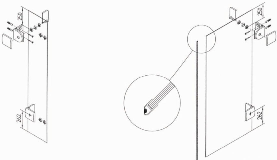
Dichtung aufstecken, Winkel anschrauben
