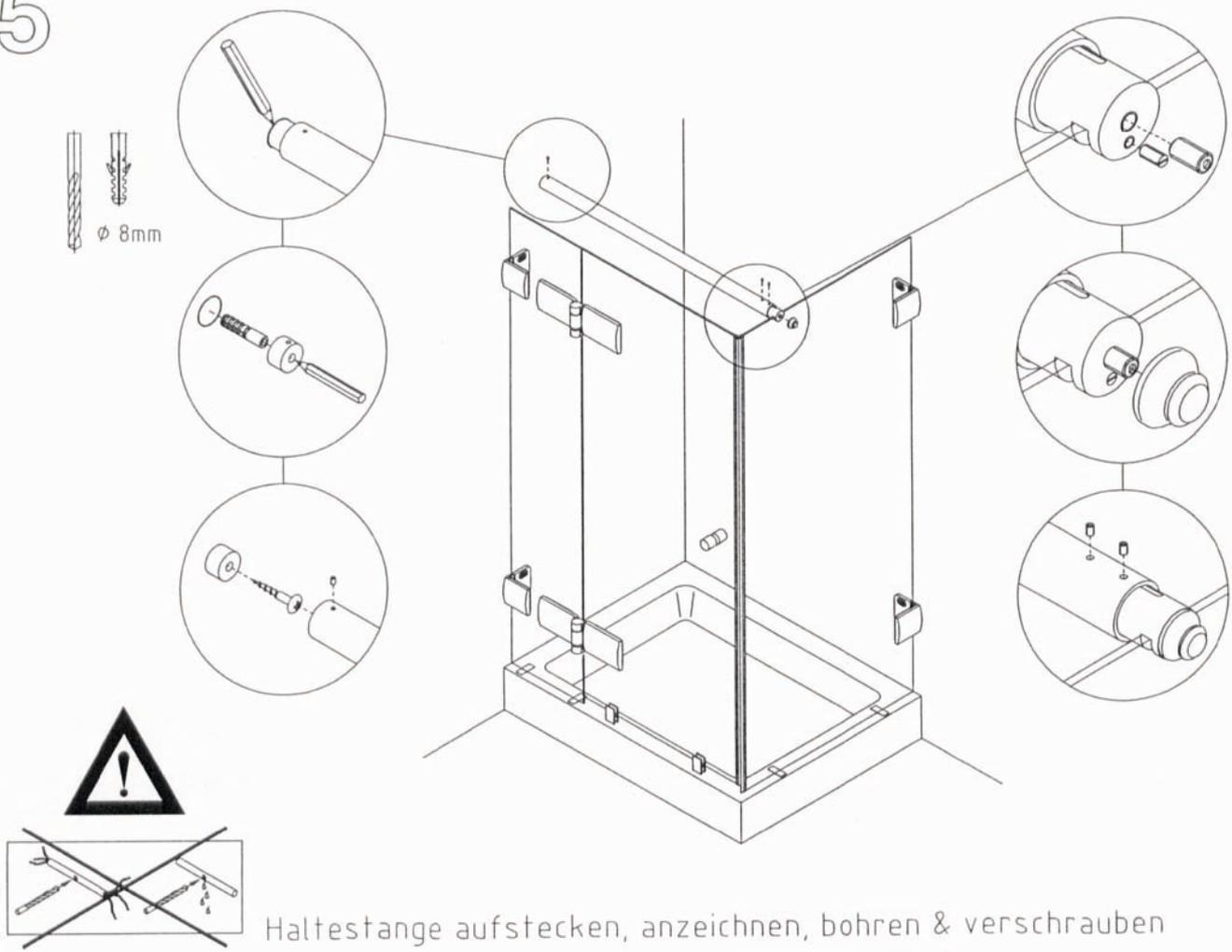
Haltestange aufstecken, anzeichnen, bohren & verschrauben
