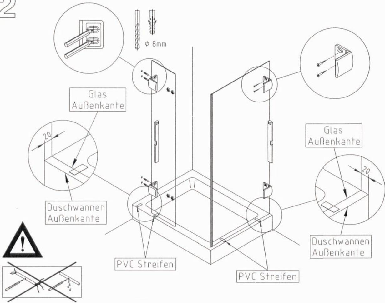
Fix- und Seitenteil ausrichten, anzeichnen, bohren und verschrauben
