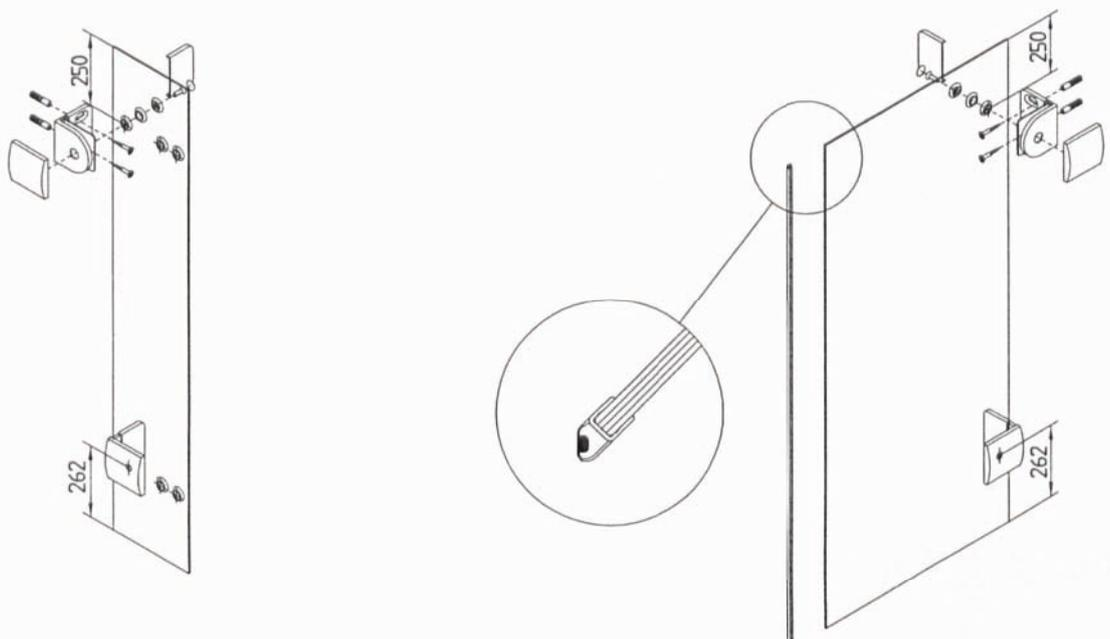
Dichtung aufstecken, Winkel anschrauben
