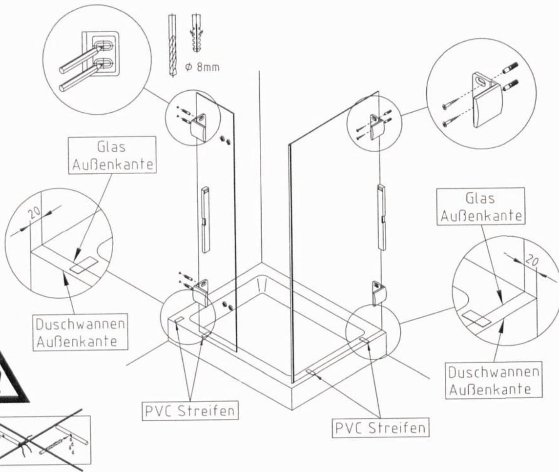
Fix- und Seitenteil ausrichten, anzeichnen, bohren und verschrauben
