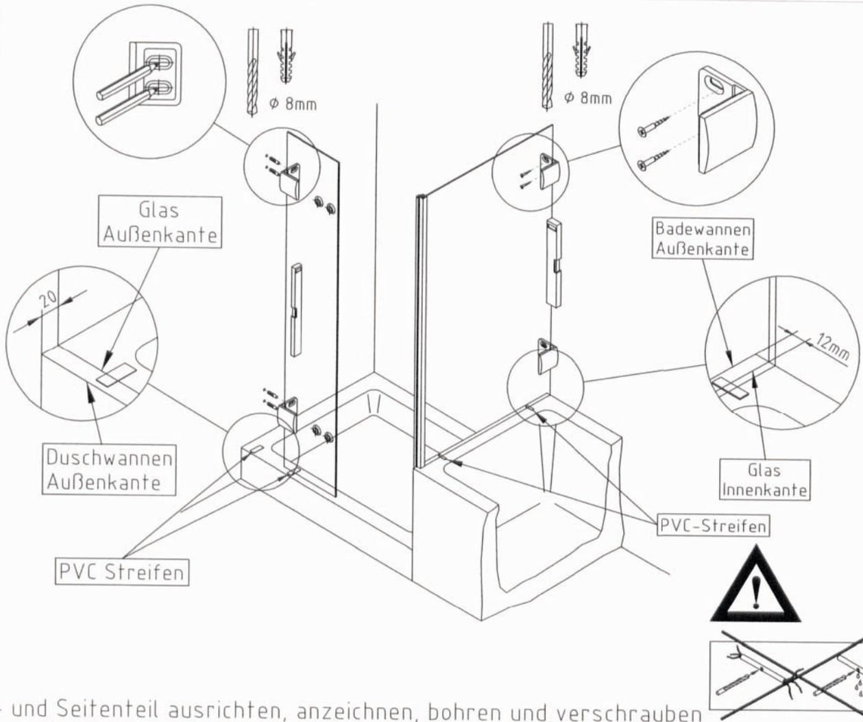
Fix- und Seitenteil ausrichten, anzeichnen, bohren und verschrauben
