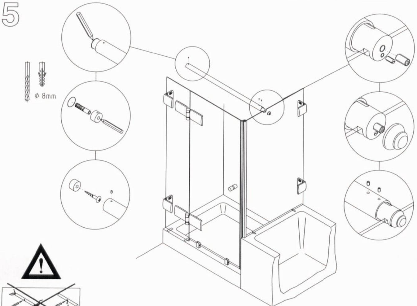
Haltestange aufstecken, anzeichnen, bohren & verschrauben
