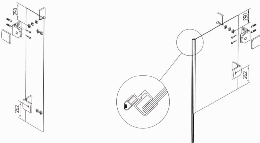
Dichtung aufstecken, Winkel anschrauben
