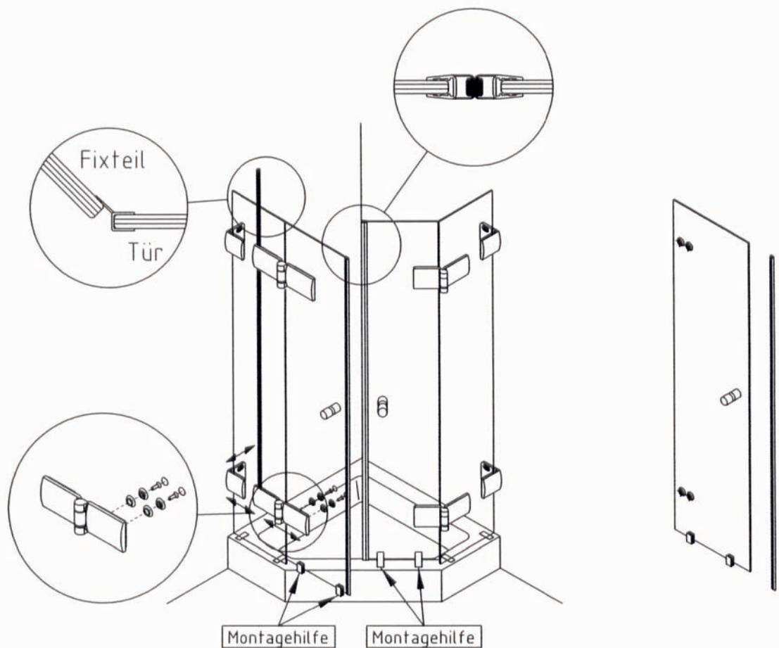
Knöpfe montieren, Dichtungen und Montagehilfen aufstecken
