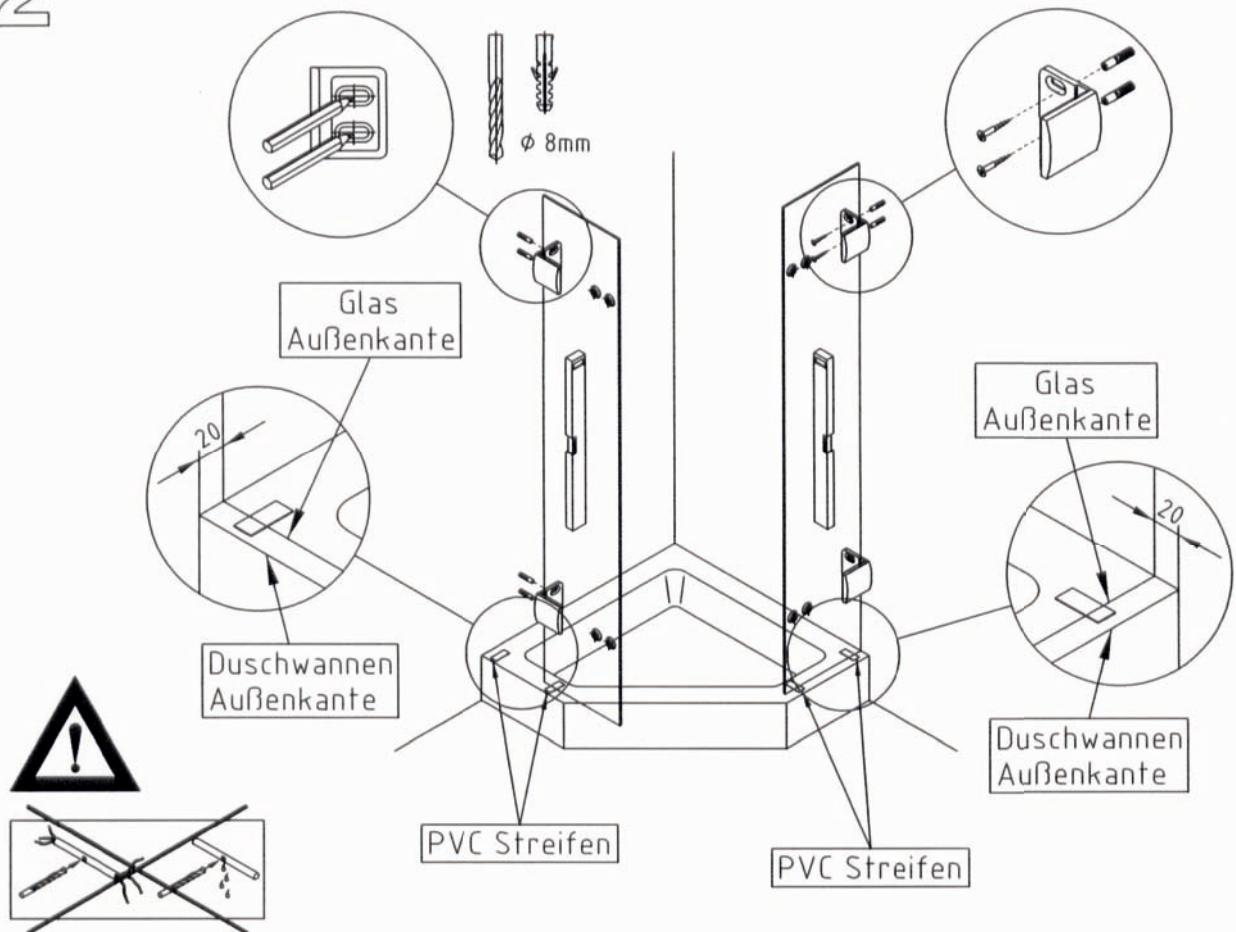
Fixteile ausrichten, anzeichnen, bohren und verschrauben
