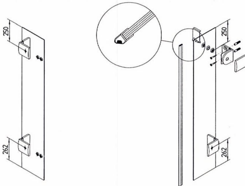
Dichtung aufstecken, Winkel anschrauben
