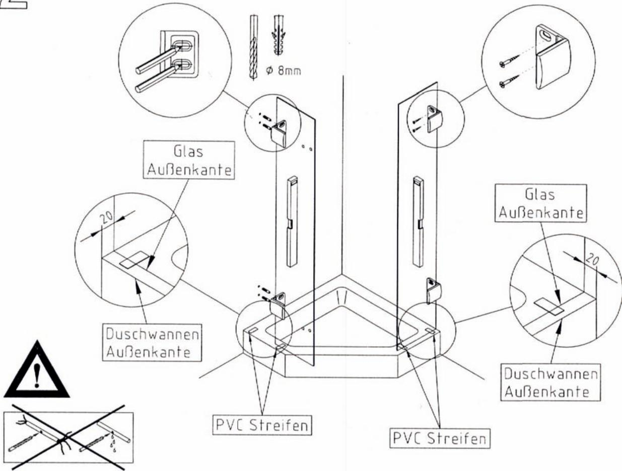
Fix- und Seitenteil ausrichten, anzeichnen, bohren und verschrauben
