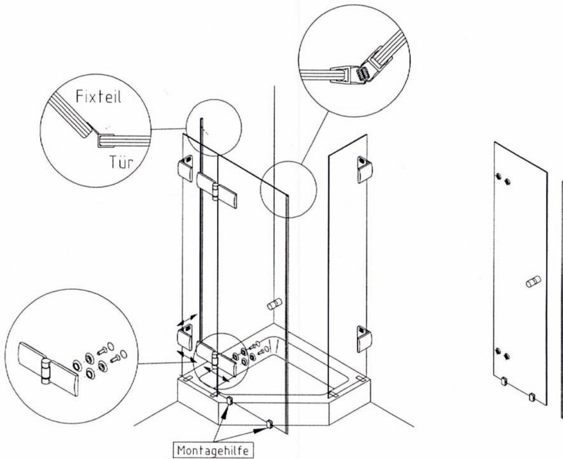
Knopf montieren, Dichtungen und Montagehilfen aufstecken
