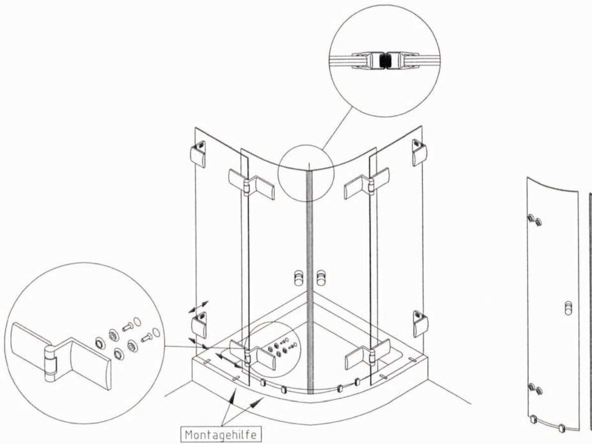
Knöpfe montieren, Dichtungen und Montagehilfen aufstecken
