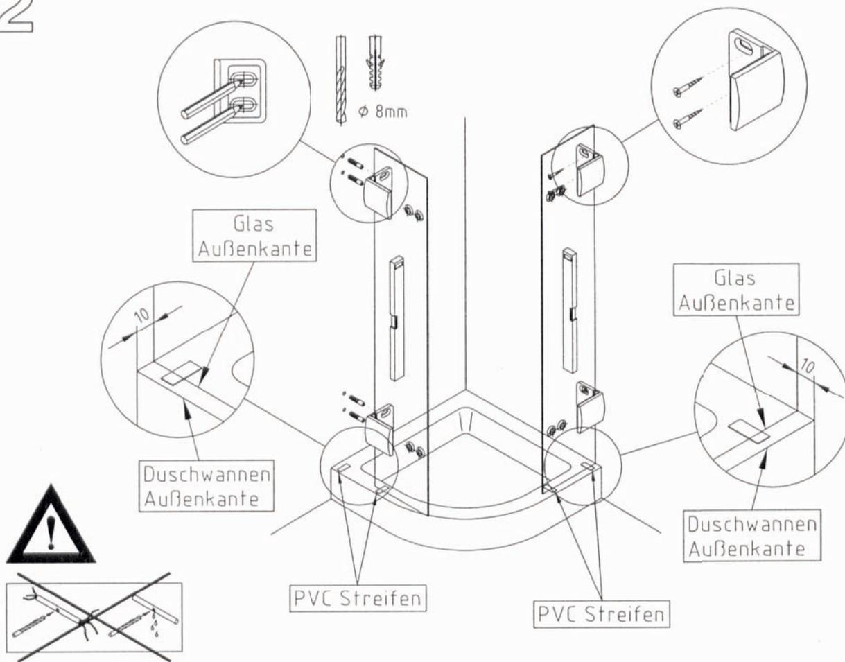
Fixteile ausrichten, anzeichnen, bohren und verschrauben
