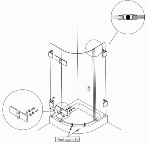
Knöpfe montieren, Dichtungen und Montagehilfen aufstecken Tür montieren und ausrichten
