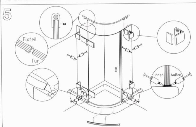
PVC-Streifen vorsichtig kürzen, Montagehilfen entfernen Dichtungen aufstecken Kappen aufkleben Fixteile innen und außen versiegeln
