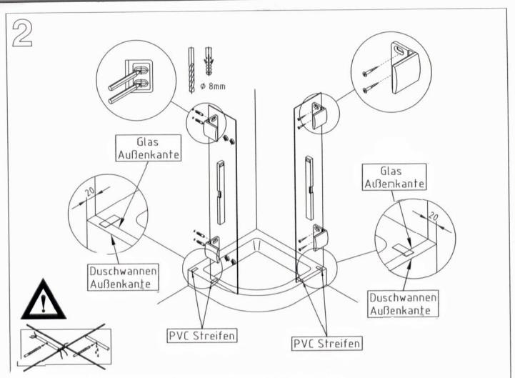
Fixteile ausrichten, anzeichnen, bohren und verschrauben
