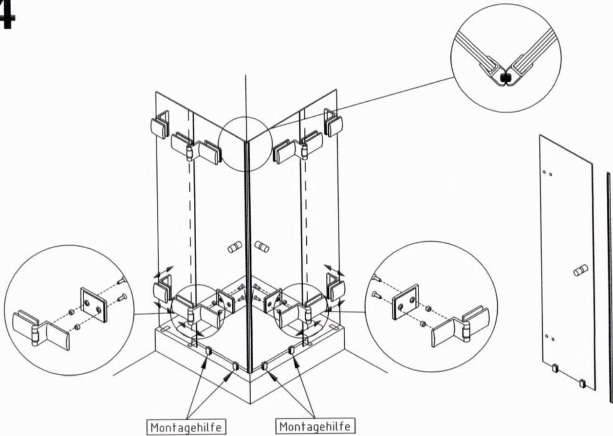
Knöpfe montieren, Dichtungen und Montagehilfen aufstecken
