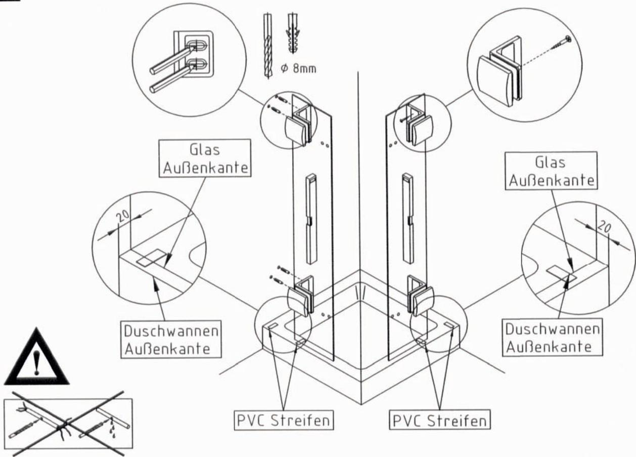
Fixteile ausrichten, anzeichnen, bohren und verschrauben
