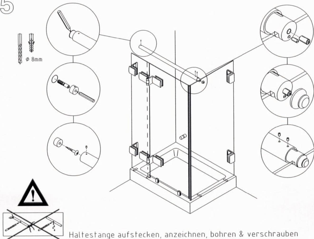
Haltestange aufstecken, anzeichnen, bohren & verschrauben
