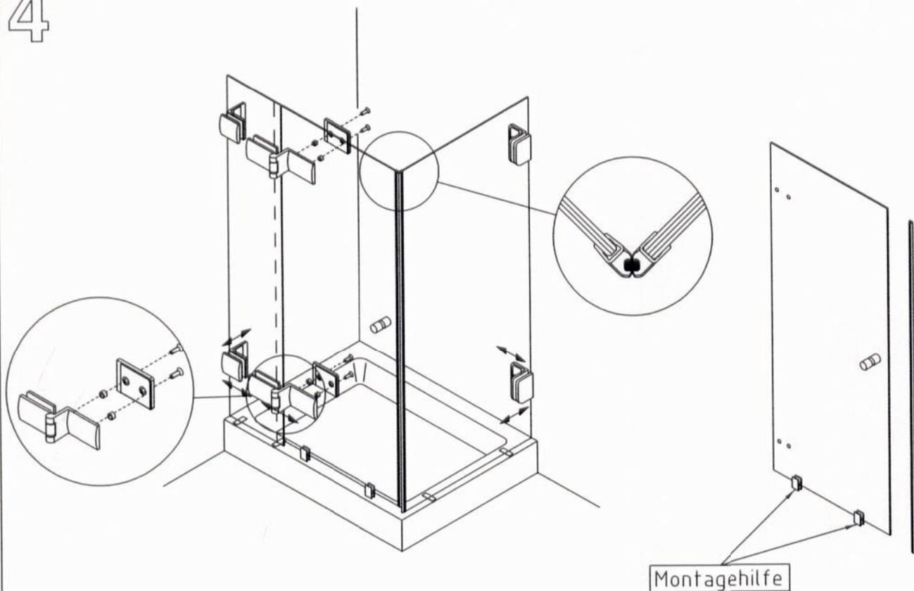
Knopf montieren, Dichtung und Montagehilfe aufstecken
