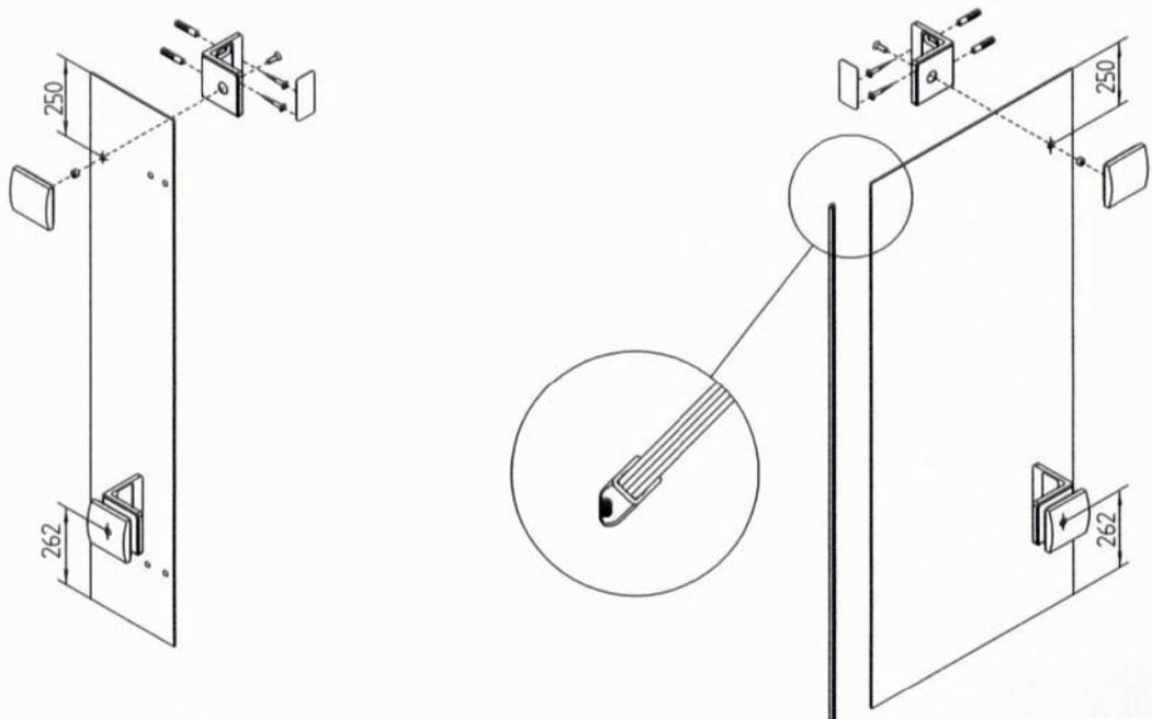
Dichtung aufstecken, Winkel anschrauben
