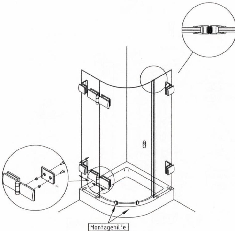
Knöpfe montieren, Dichtungen und Montagehilfen aufstecken
