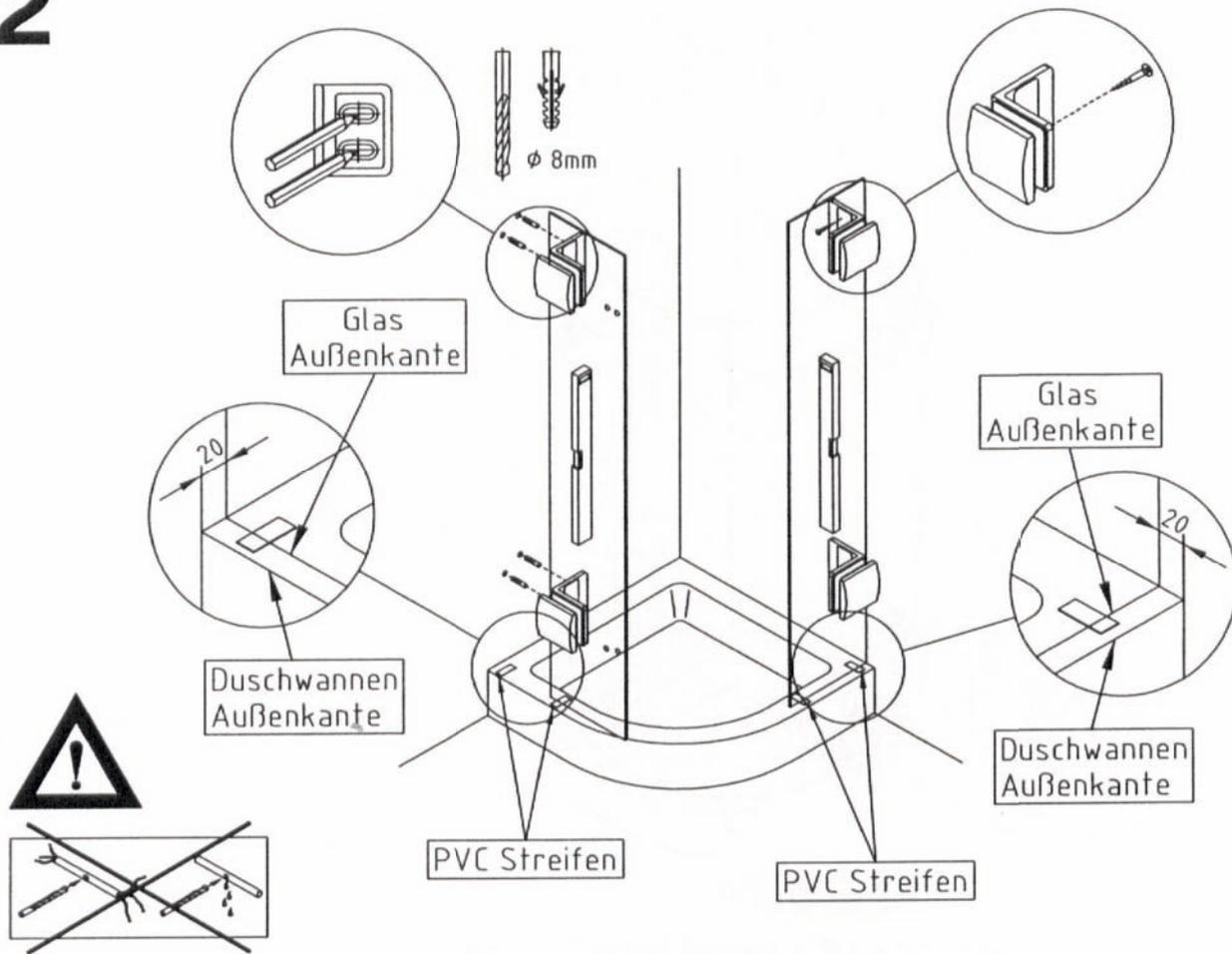
Fixteile ausrichten, anzeichnen, bohren und verschrauben
