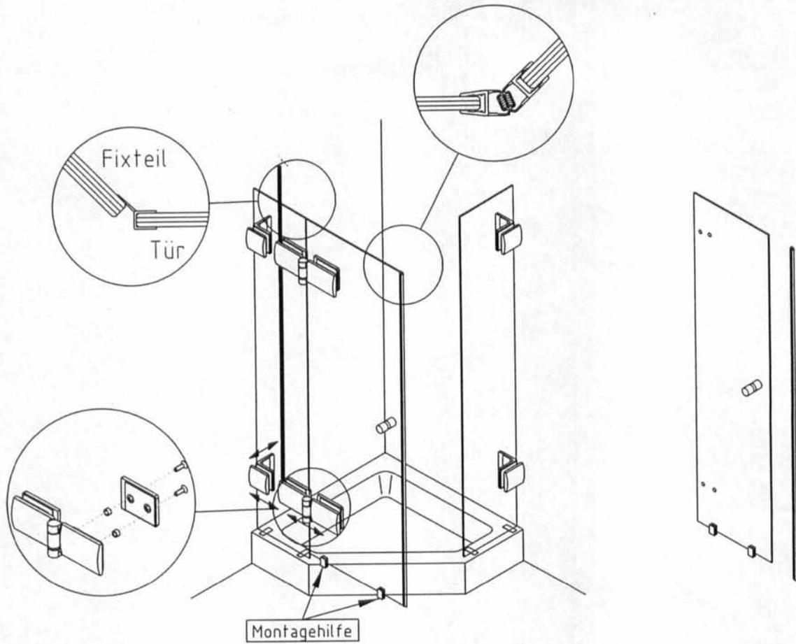
Knopf montieren, Dichtungen und Montagehilfen aufstecken
