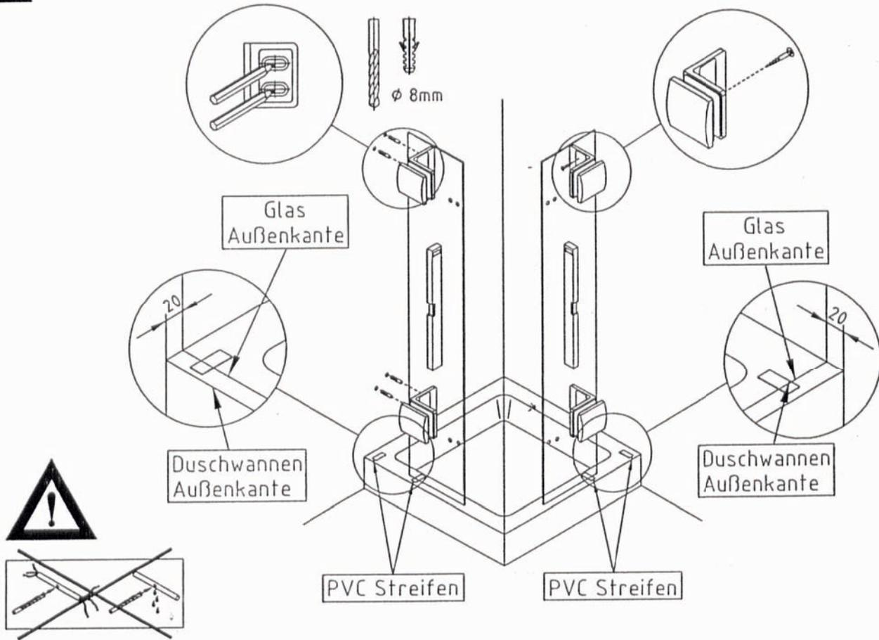
Fixteile ausrichten, anzeichnen, bohren und verschrauben
