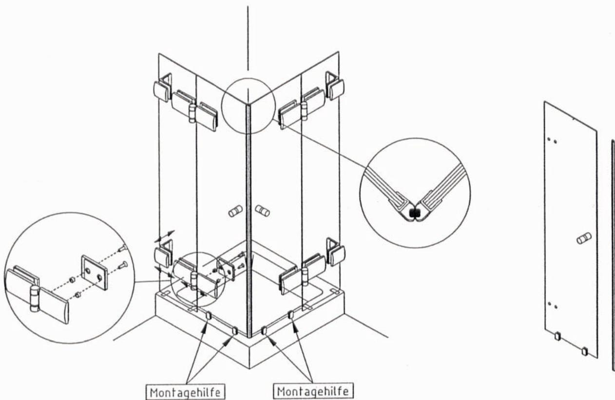
Knöpfe montieren, Dichtungen und Montagehilfen aufstecken
