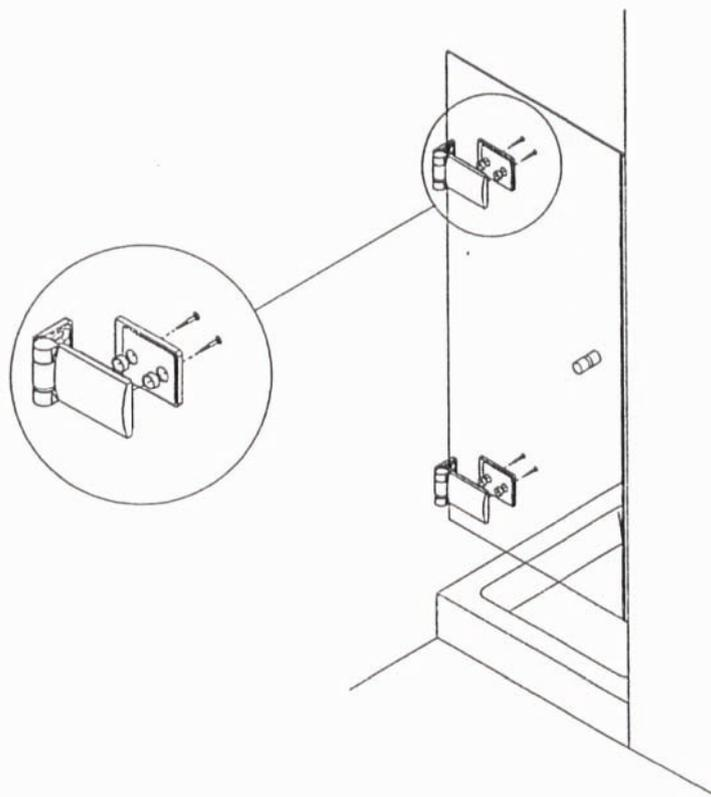
Bänder an der Tür befestigen und ausrichten
