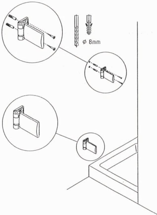
Löcher bohren und Bänder anschrauben
