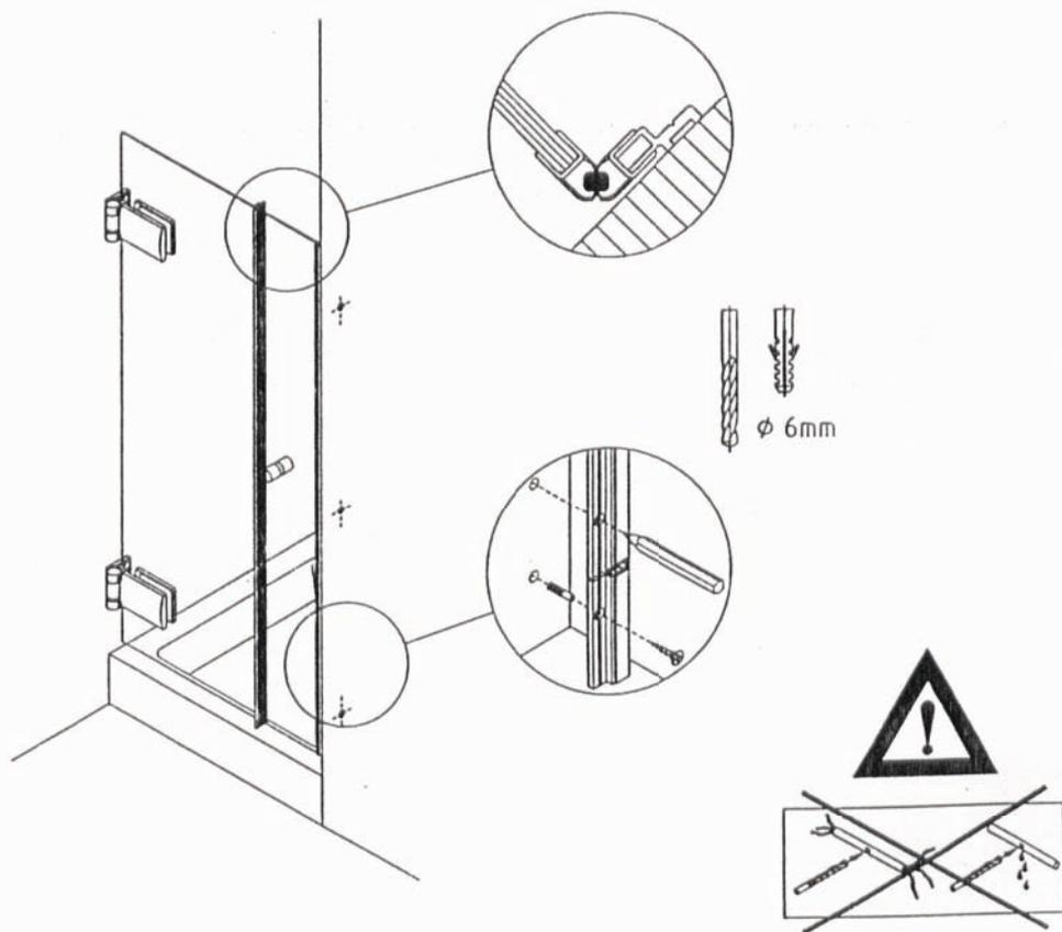
Magnetleistenträger an Dichtung anhalten, anzeichnen, bohren und verschrauben
