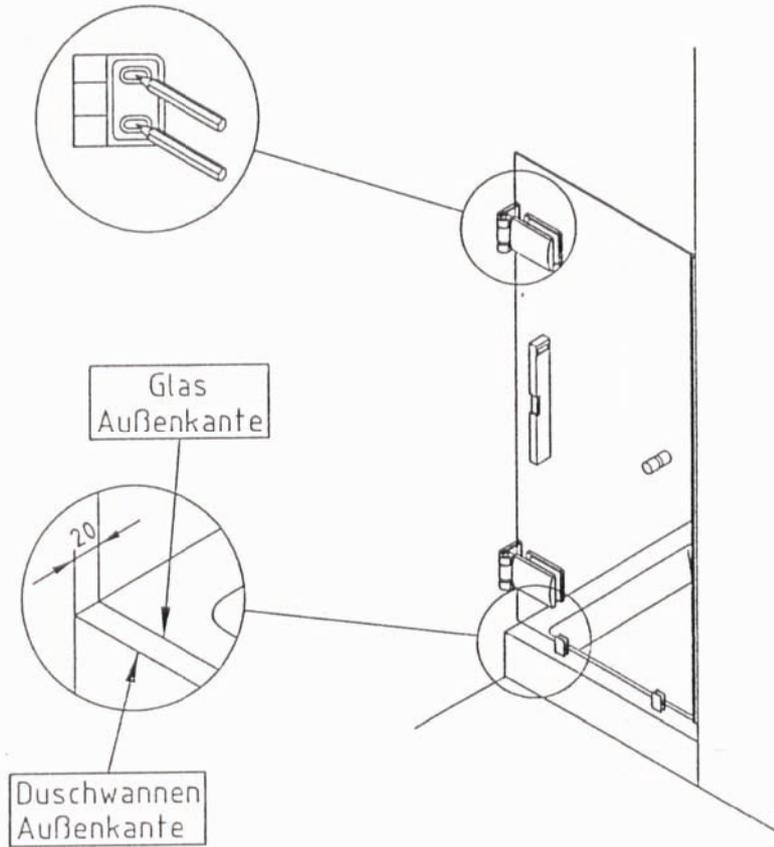
Tür ausrichten und Bohrungen anzeichnen
