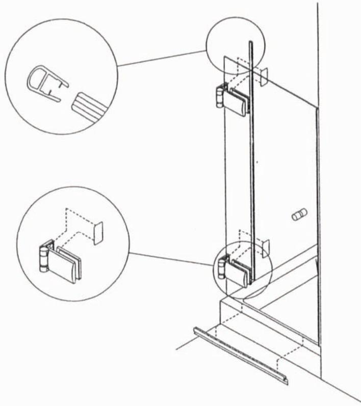
Dichtungen aufstecken und Dichtlippe an den Bändern einschneiden
