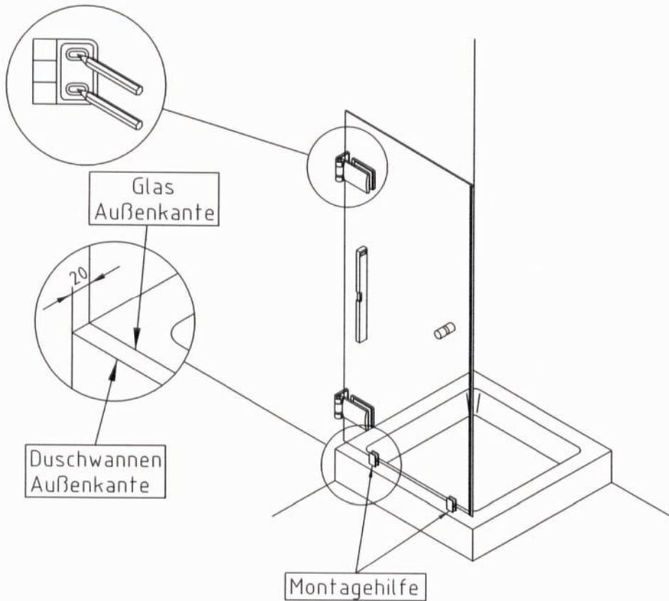
Tür ausrichten und Bohrungen anzeichnen
