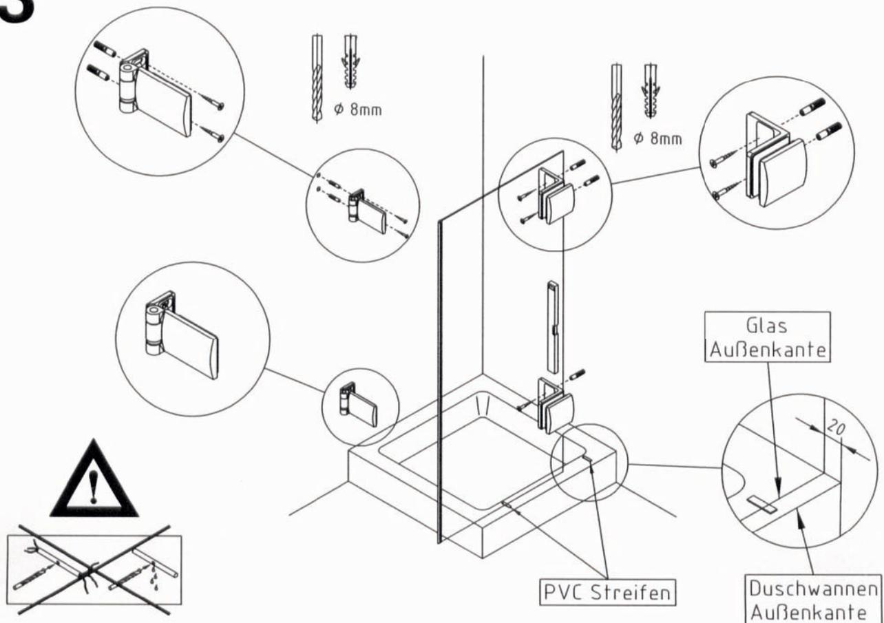
Löcher bohren & Bänder und Winkel anschrauben
