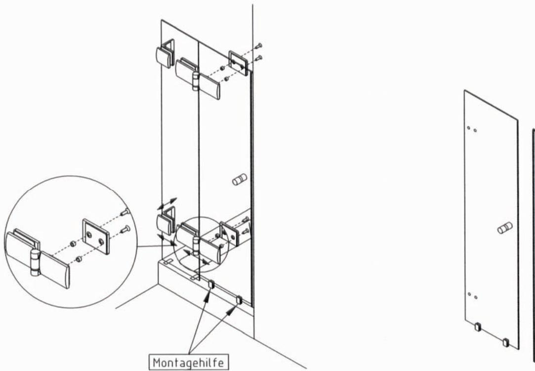
Knopf montieren, Dichtung und Montagehilfen aufstecken
