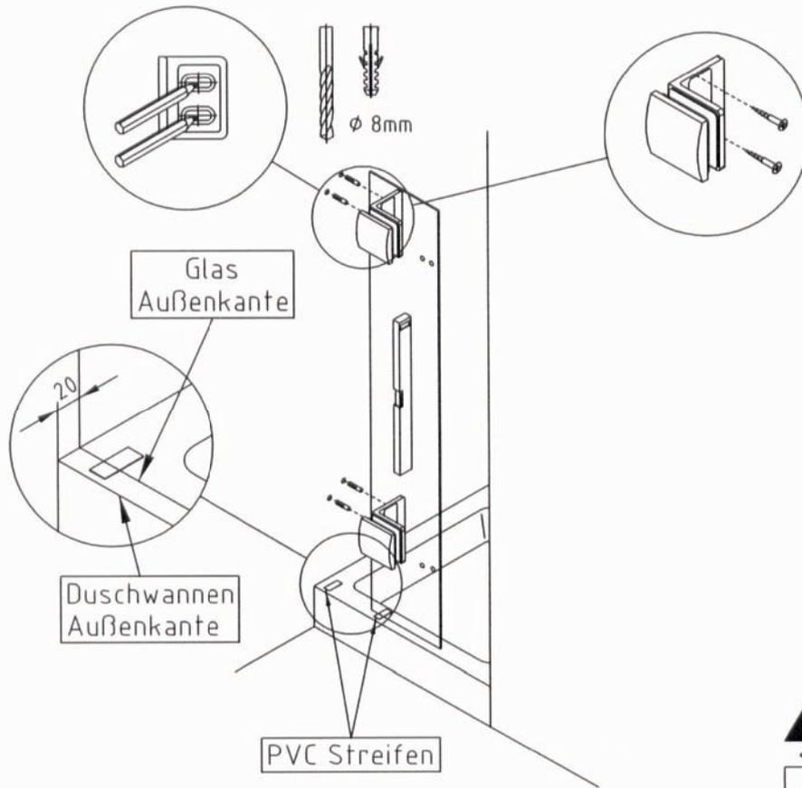
Fixteil ausrichten, anzeichnen, bohren und verschrauben
