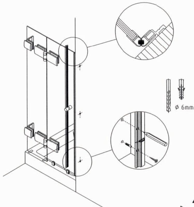
Magnetleistenträger an Dichtung anhalten, anzeichnen, bohren und verschrauben
